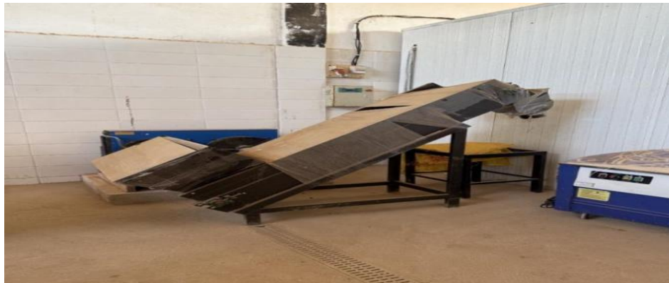
Figure 26: Convoyeur inox pour le transport automatisé des moules entre les stations de traitement.
