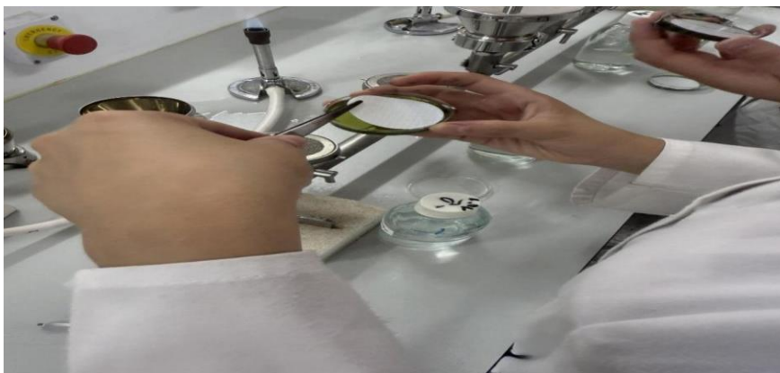
Figure 47: Mise en place des membranes filtrantes dans les boites de pétris.
