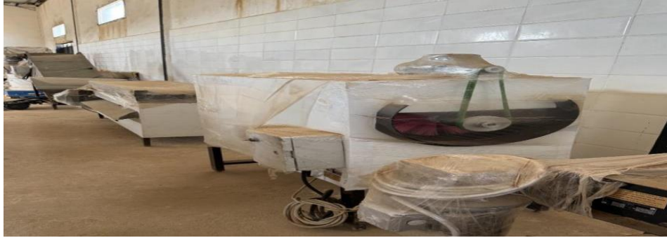
Figure 25: Brosseuse tournante à moules utilisée pour le nettoyage mécanique des moules.
