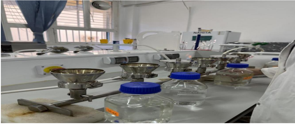
Figure 45: Système de filtration.
