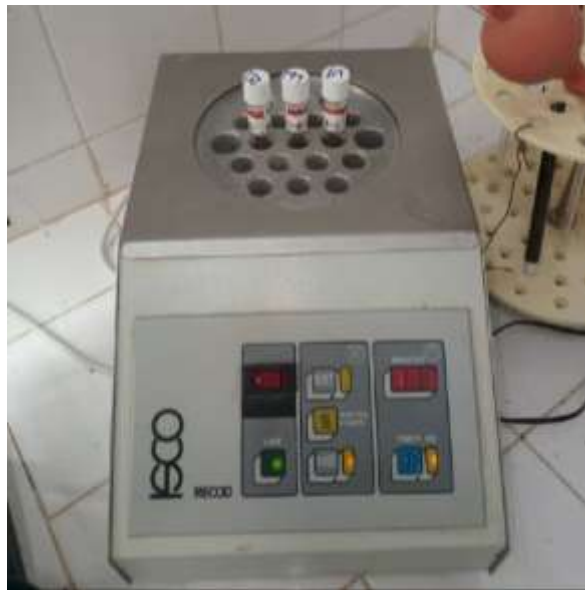
Figure III-13: Bloc de digestion thermique RECOD (thermoréacteur) employé pour le prétraitement des échantillons avant l'analyse de la demande chimique en oxygène (DCO).
