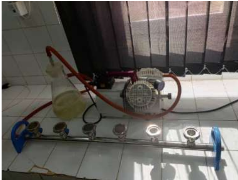
Figure III-12: filtre à pompe à 6 postes (unité de filtration sous vide)
