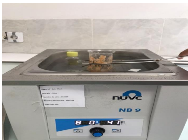
Annexe I-Figure 9 : L'inactivation de l'enzyme dans le bain marie à 90°C pendant 10 min.
