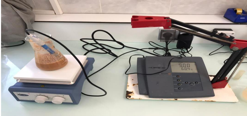
Figure II- 2 : Dispositif d'hydrolyse enzymatique selon la méthode pH-Stat.
