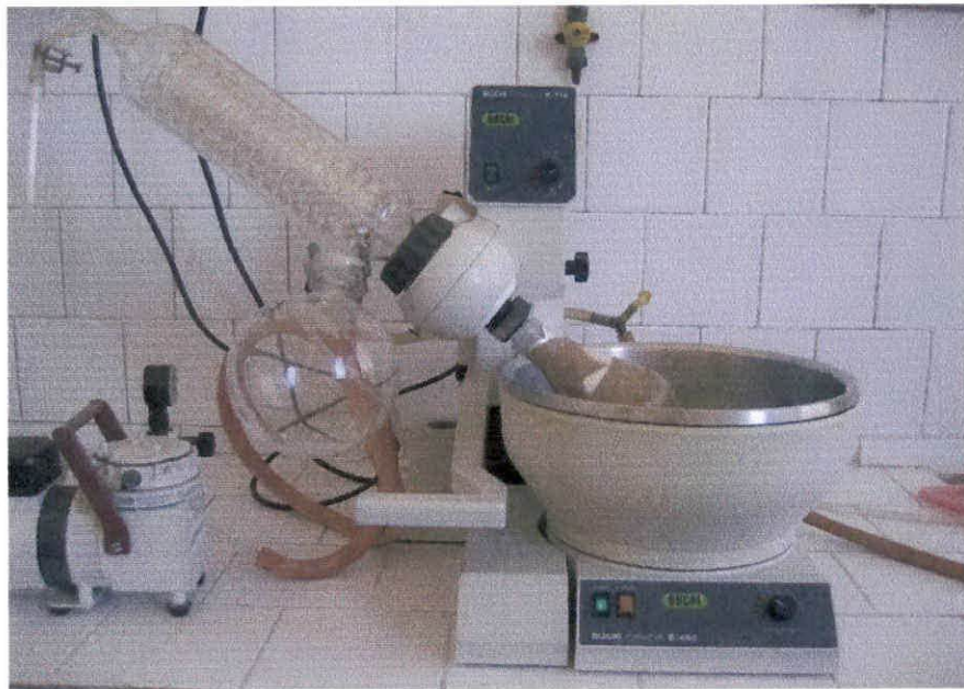
Photo 02 : Evaporation du solvant dans un Rotavapor (Sali, 2007).
