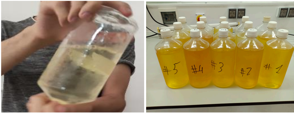
Figure 26 : Homogénéisation de l'échantillon ( présent travail ).
