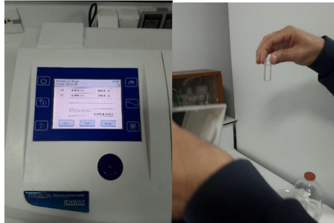
Figure 28. Mesure de l'absorbance de l'extrait chlorophyllien à l'aide du spectrophotomètre
