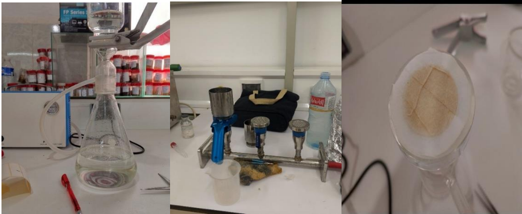
Figure 25. Réalisation personnelle de la filtration de l'échantillon pour l'analyse du chlorophylle a
