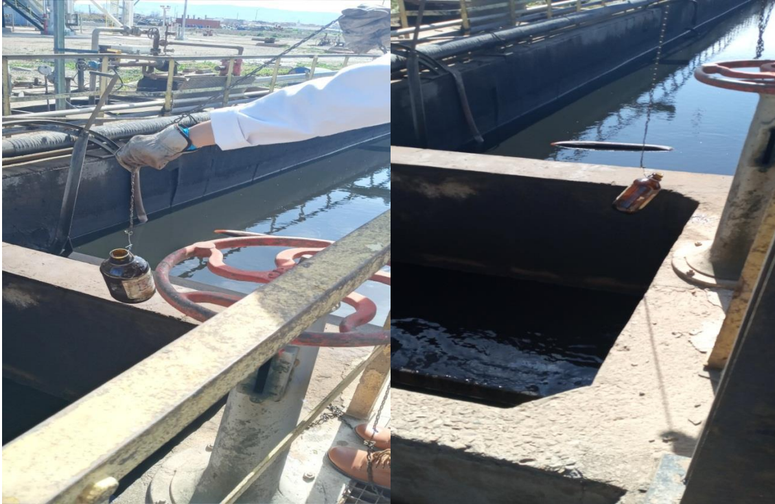
Figure 1 : Prélèvements des échantillons en amont au niveau après l'écumeur au niveau de bassin API.
