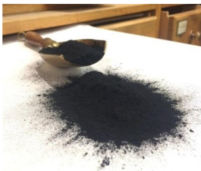
FIGURE 4 : CHARBON ACTIF EN POUVRE.
