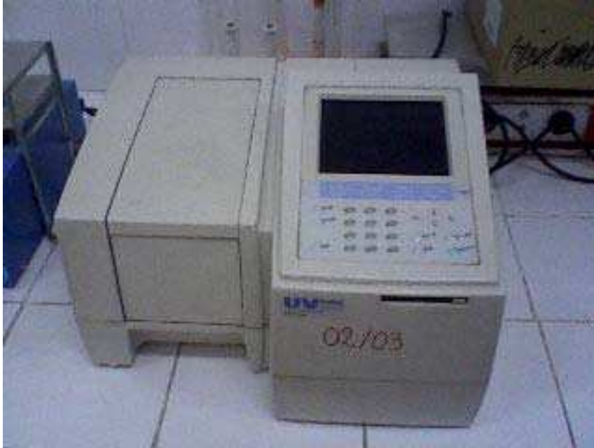
Figure n° 2 : Image d'un spectrophotomètre UV/VIS (SHIMADZU) type MINI 1240.
