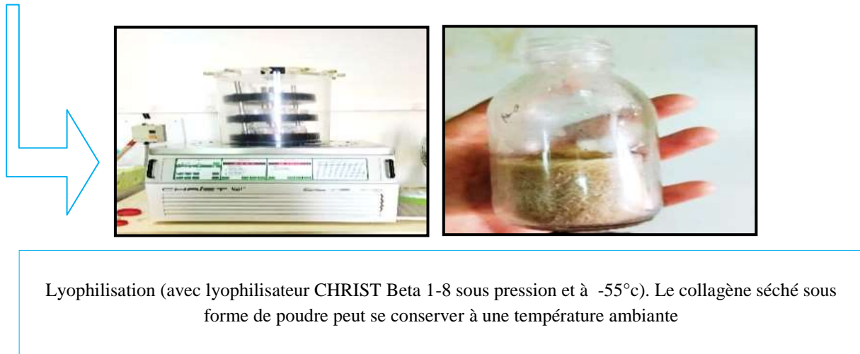
Figure II-3 : Diagramme général d'extraction du collagène à partir des peaux de poissons
