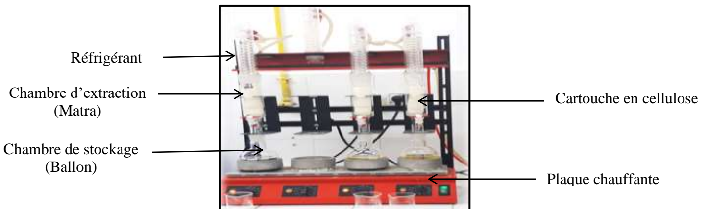
Figure 25 : Extracteur de Soxhlet
