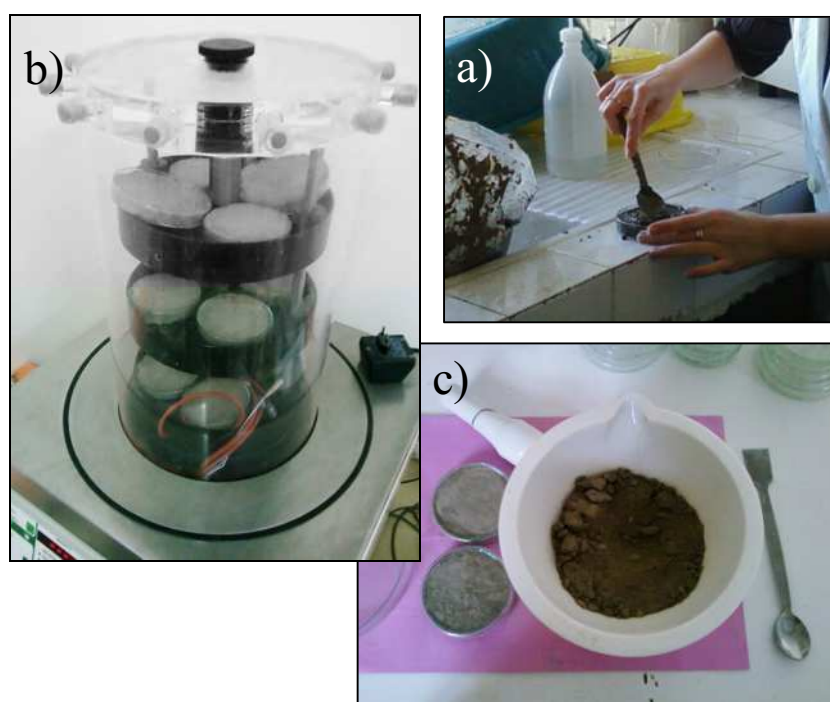
Figure 15 : Lyophilisation des sédiments : a) remplissage des sédiments mouillés dans les boîtes de pétri, b) lyophilisation et c) homogénéisation.
