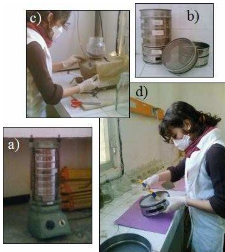
Figure 19 : a) Colonne vibrante, b) tamis, c) pesée des fractions granulométriques et d) récupération du reste des grains à l'aide du pinceau.
