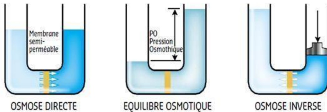
Figure 7: Le principe de fonctionnement de l'osmose inverse (Degremont, 2010).
