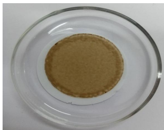
Figure VI-7 : Précipité de Struvite humide retenu sur la membrane filtrante
