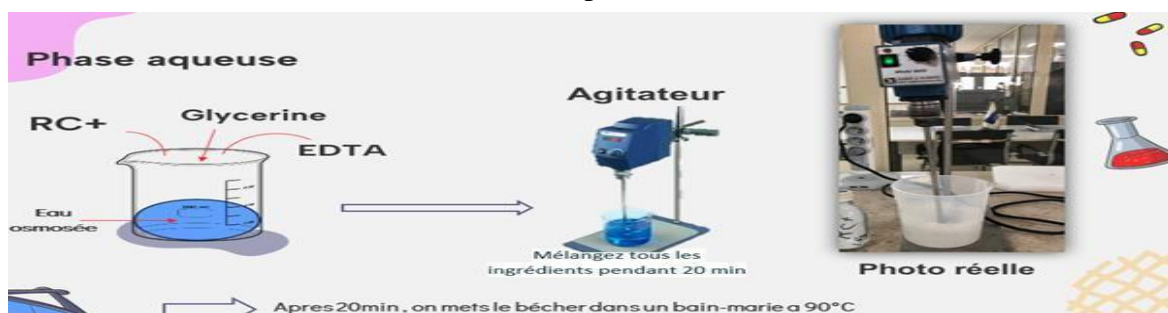
Figure 14 : Schéma explicatif de la préparation de la phase aqueuse.
