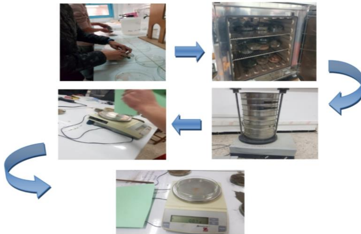
Figure 26: Les étapes de l'analyse granulométrique (ENSSMAL).
