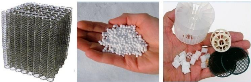
Figure 19 : Quelques exemples de matières de Bio filtration. Gauche – BioBloc, Centre - Billes de polystyrène, Droite – Média machiné mélangé(RETINK et CANADIAN AQUACULTURE SYSTEM,2010).
