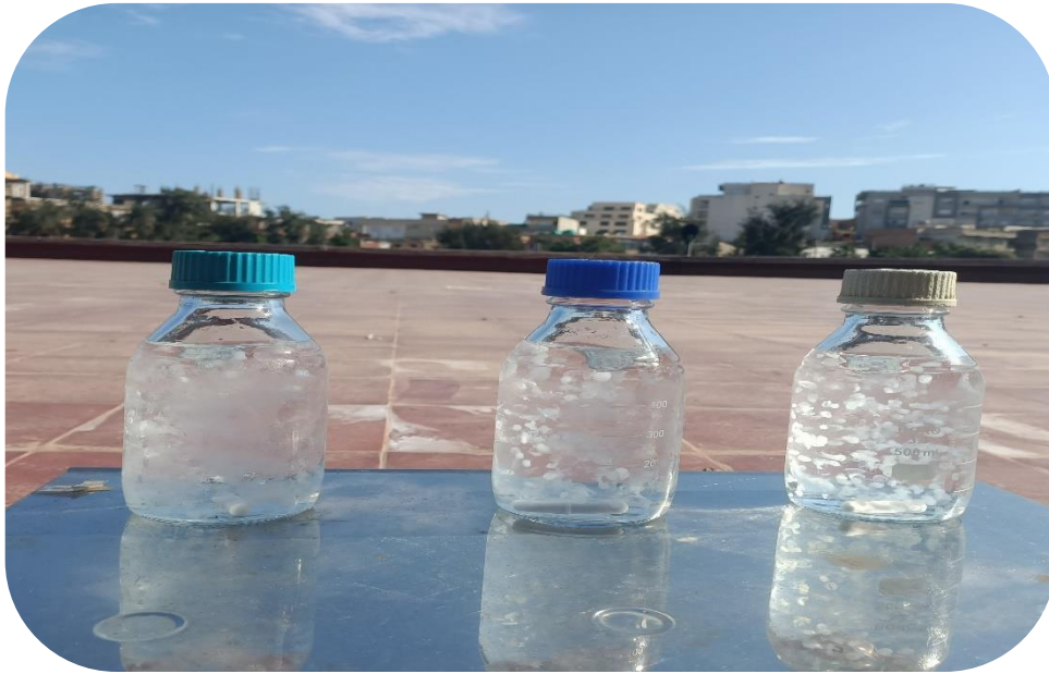
Figure II.23 : Désinfection aux billes de chitosane UV- Solaire des eaux contaminées par L. pneumophila
