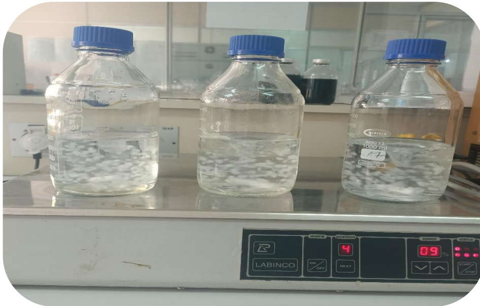
Figure II.22: Désinfection aux billes de chitosane des eaux contaminées par L. pneumophila
