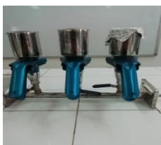
Figure (V.6) : Rampe de filtration
