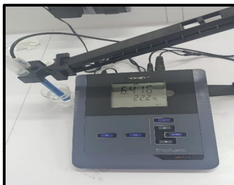
Figure 11 : pH mètre utilisé (mesure du pH et de la température)
