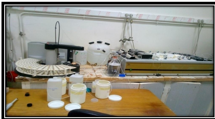
Figure 9: Appareil d'analyse des sels nutritifs Skalar® San + Analyzer.
