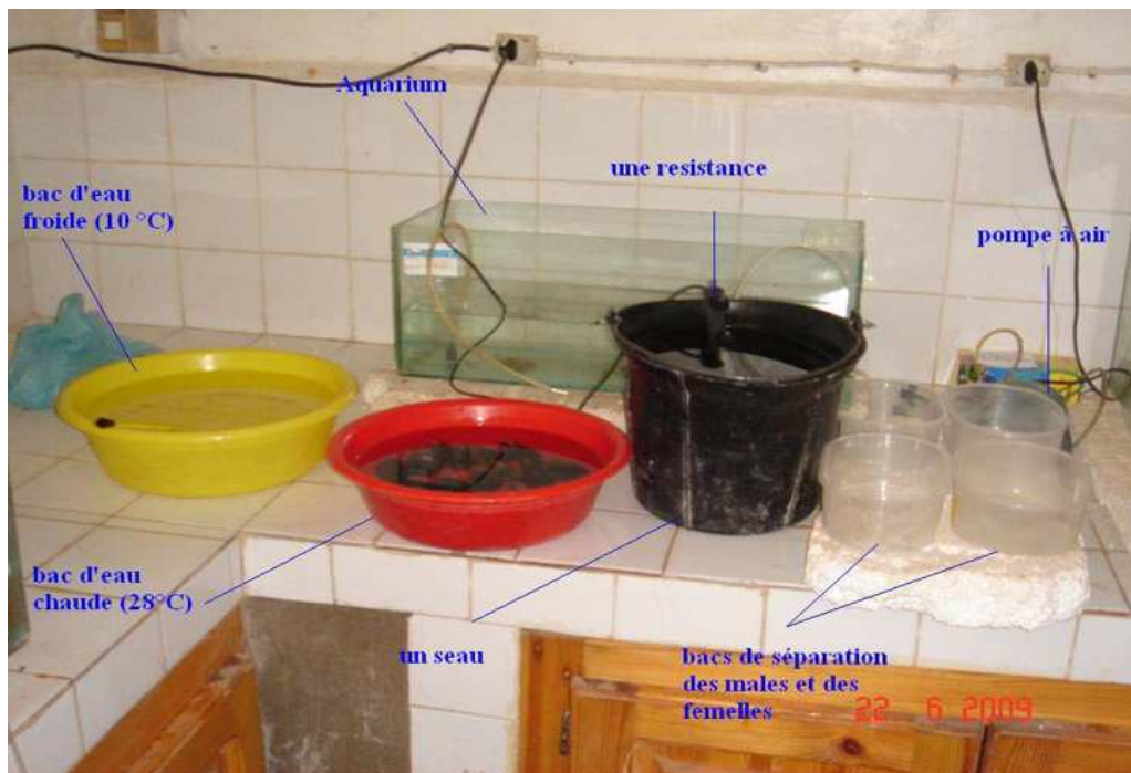
Figure n°18 : Matériel utilisé pour l'induction artificielle de la ponte par choc thermique Chez les moules.
