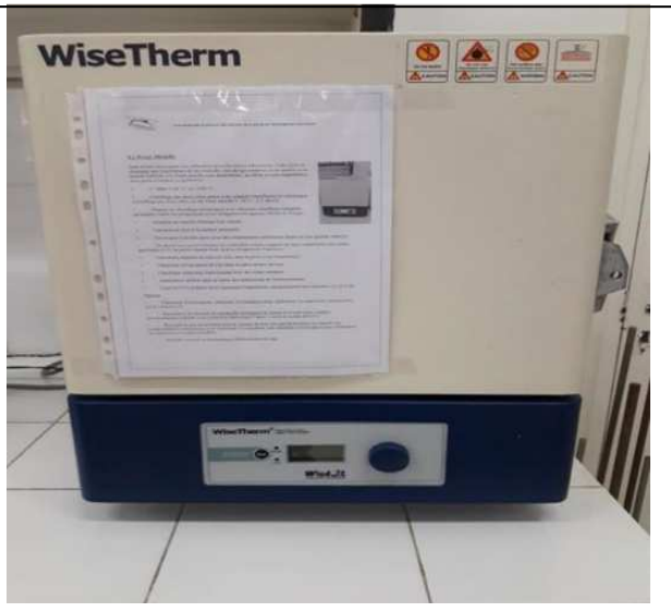
Figure 8: Four à moufle de marque Wisetherm®
