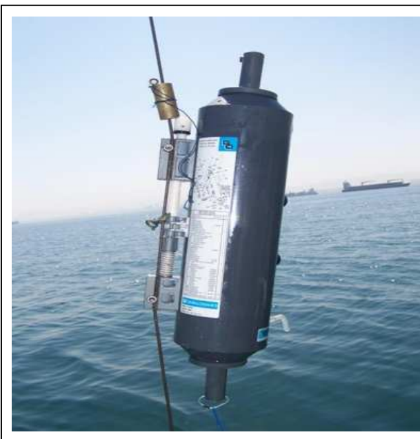
Figure 3: Bouteille de prélèvement NISKIN (ecosyismal)
