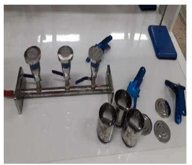
Figure 6: Rompe de filtration de marque Millipore®
