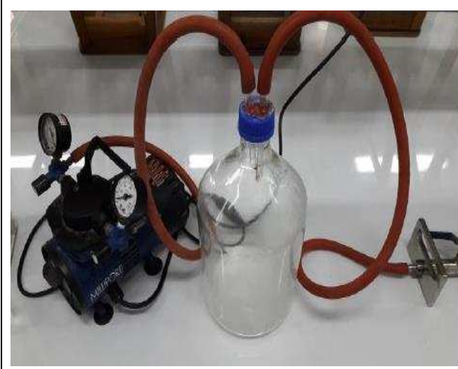
Figure 5: Dispositif de filtration de marque Millipore®
