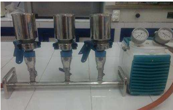
Figure III.8 : Rompe de filtration
