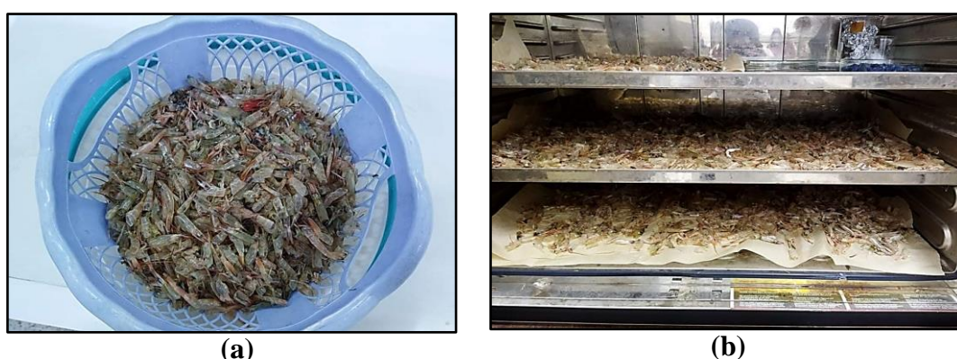
Figure 12 : Prétraitement des carapaces de crevettes, (a) Carapaces lavées, (b) Séchage des carapaces dans l'étuve
