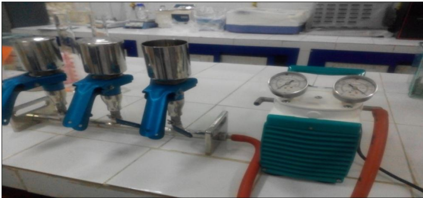
Figure 22 : Dispositif de l'appareil de filtration sur membrane.
