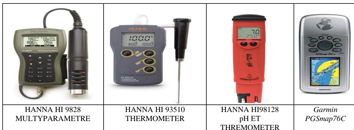
Figure 18. Instruments utilisés dans la prise des mesures in-situ au Koweït.
