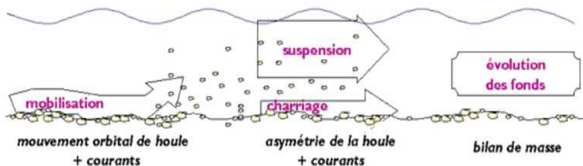
Figure V.1 : Schéma de principe du transport des sables et des graviers (source : www.ifremer.fr ).
