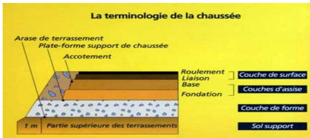
Figure I-13 : schéma de principe d'une structure routière ( source : www.planete-tp.com ).
