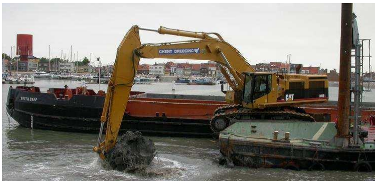
Figure I-06: Drague mécanique à pelle ( www.ghentdredging.be )
