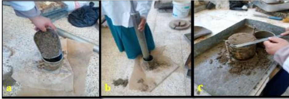
Photo III-07: les étapes principales de l'essai Proctor modifié.
