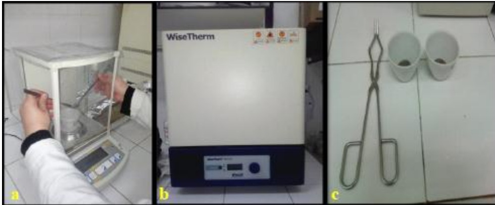
Photo III-03 : Les étapes principales de détermination de la teneur en MO.
