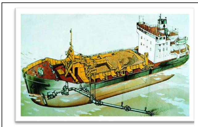
Figure I-08: Drague aspiratrice en marche (Source : Foucher. J, 2005).
