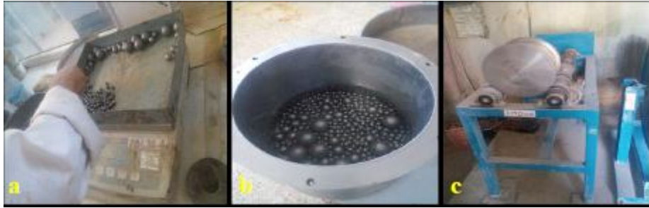
Photo III-08 : Les étapes principales de l'essai de friabilité de sable.
