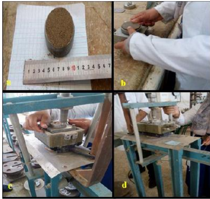
Photo III-11 : Les étapes principales de l'essai de cisaillement direct.
