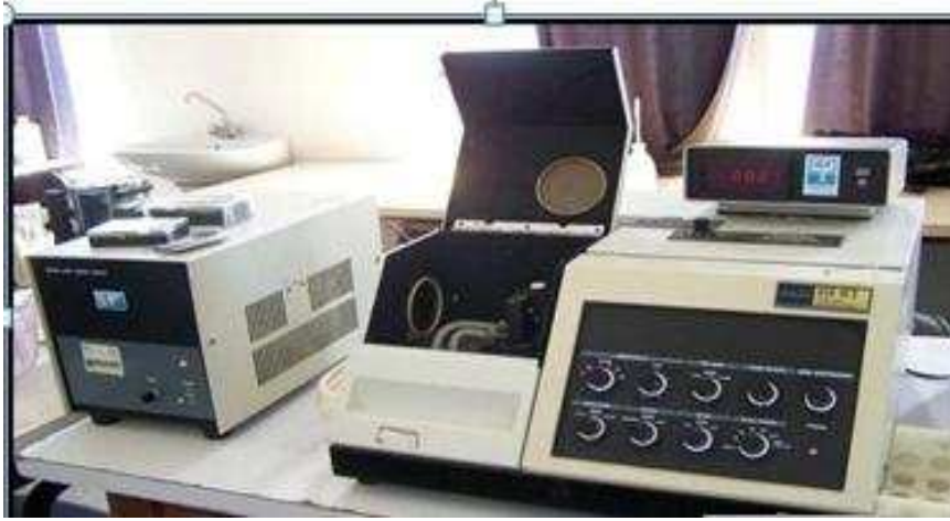
Figure 12: Spectrophotomètre de fluorescence HITACHI, modèle 650 S, équipé d'une lampe «Xénon»
