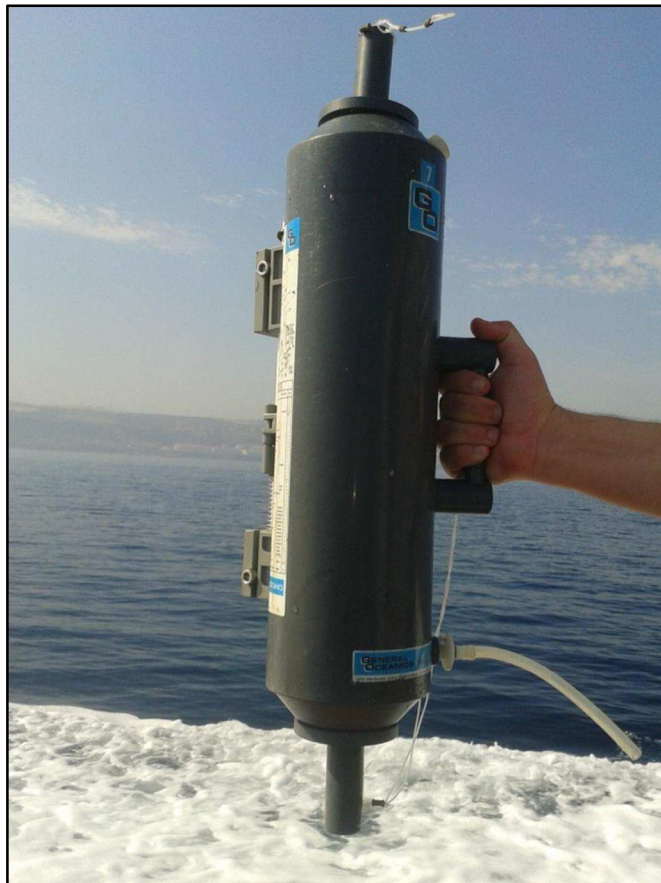
Figure 10: bouteille de prélèvement de type NISKIN.
