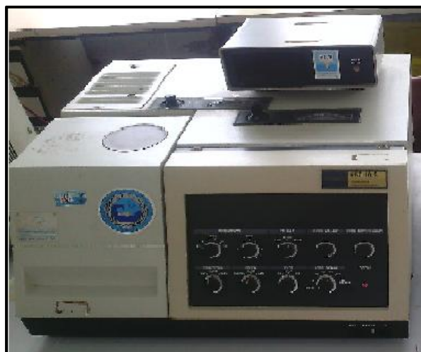
Figure 16: Spectrofluorimètre à rayonnement ultraviolet HITACHI.
