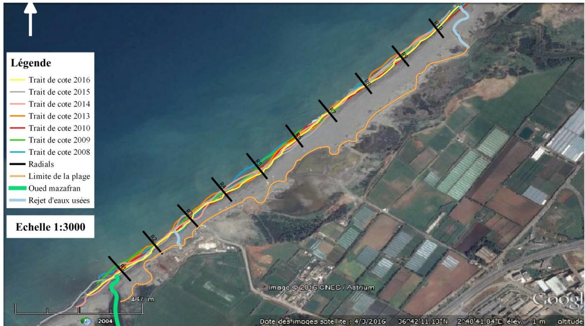
Figure 20 : Carte représente les différents traits de côte des différentes années de la plage el kheloufi. (Google Earth 2016)
