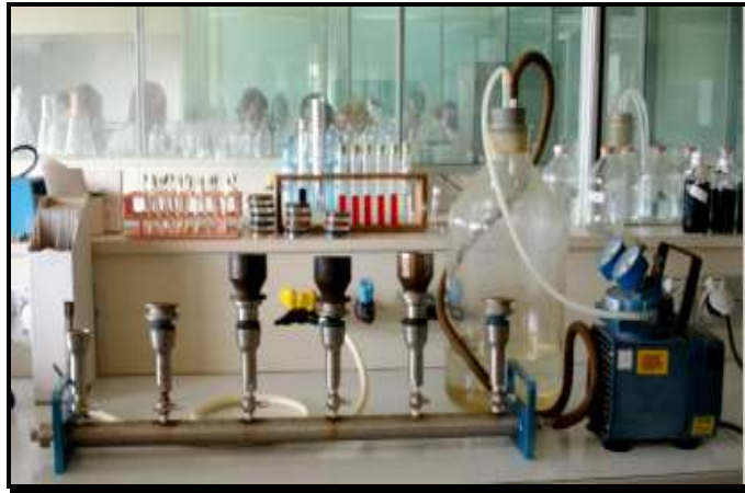
Figure 18 : Dispositif de l'appareil de filtration sur membrane.
