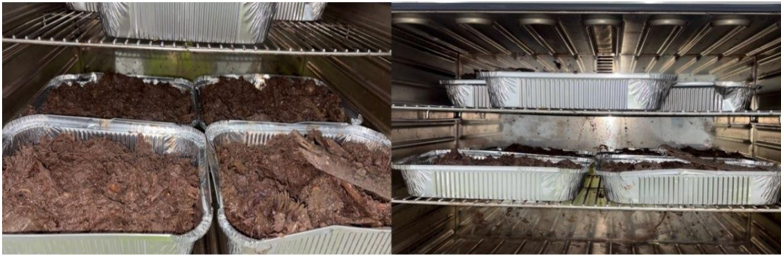
Figure 23. Apparition d'un gradient d'humidité et d'un début de fermentation anaérobie lors du séchage des coproduits en couches épaisses.
