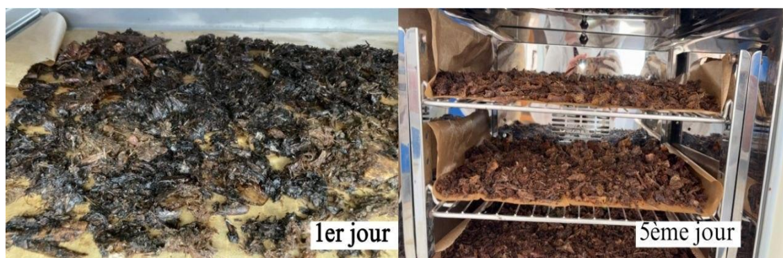
Figure 24. Optimisation cinétique du traitement thermique de la farine expérimentale : Comparaison de l'état macroscopique entre le début (1 er ) et la fin (5 ème jour) du séchage.
