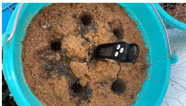
Figure 20. Prise de mesure de la température centrale du substrat pour le contrôle de l'activité microbienne.
