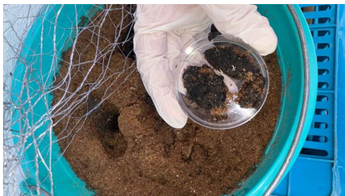
Figure 21. Prélèvement d'échantillons représentatifs du compost pour le suivi cinétique du pH.
