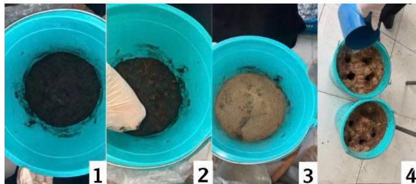
Figure 17. Procédé de chargement du bioréacteur par stratification alternée des substrats.
