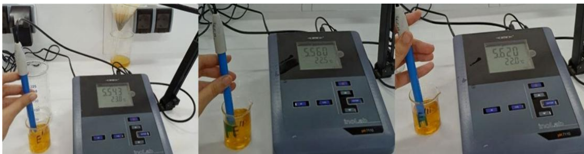
Figure 06. Dispositif expérimental et étapes de mesure du pH des solutions d'analyse à l'aide d'un pH-mètre de précision.
