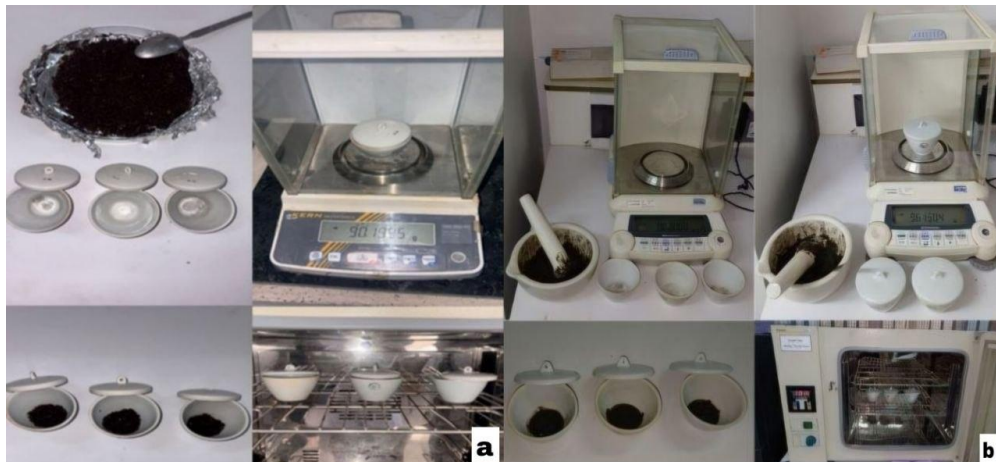
Figure 05. Étapes de pesée et de préparation thermogravimétrique pour l'analyse de la siccité de la farine de poisson (a) et des boues de STEP (b) .
