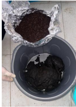
Figure 16. Incorporation et pré-mélange mécanique de la farine de poisson et des boues d'épuration déshydratées.
