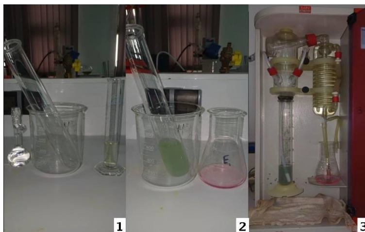
Figure 11. Différentes étapes du procédé de distillation (Méthode de Kjeldahl).
