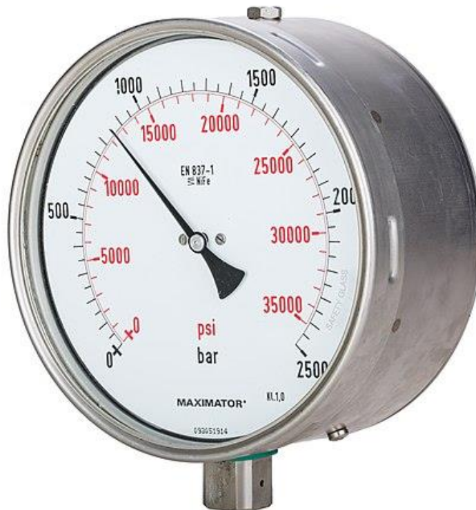
Figure I.10. Manomètre haute pression (0-2500 bar). ( https://fr.wikipedia.org/wiki/Manom%C3%A8tre ).
