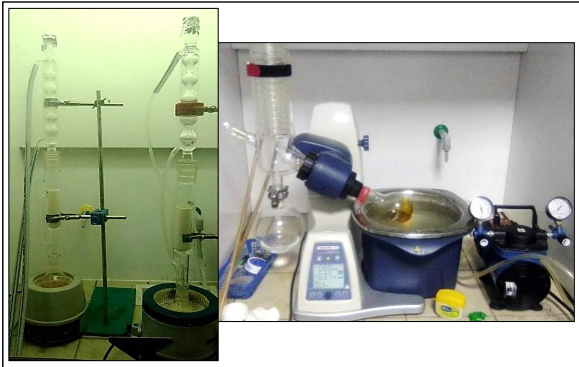
Figure 7: Montage Soxhlet et Rota vapeur
