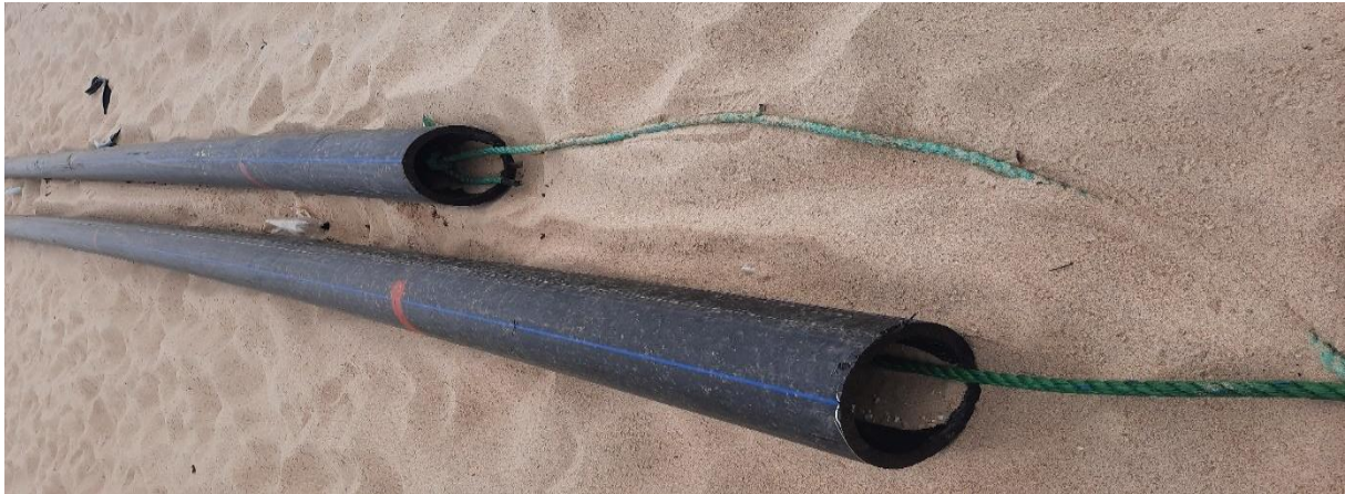
Figure 29: Tube de polyéthylène haute densité (PE 100) de 200 mm.
