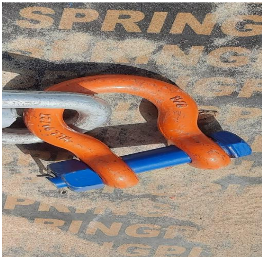
Figure 35: Une manille de 9.5 mm.
