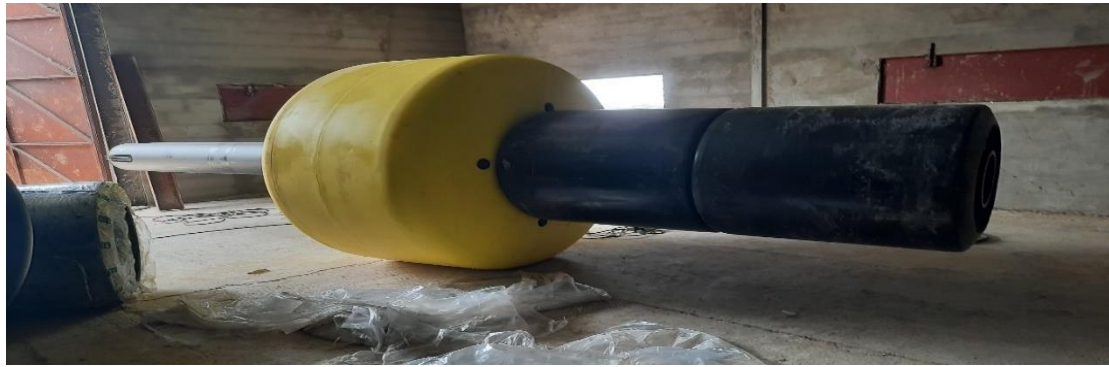
Figure 31: Une bouée de navigation en cour d'assemblage.
