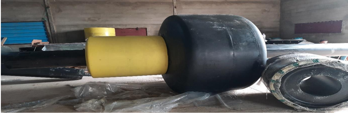
Figure 47: l'assemblage de la balise à terre.
