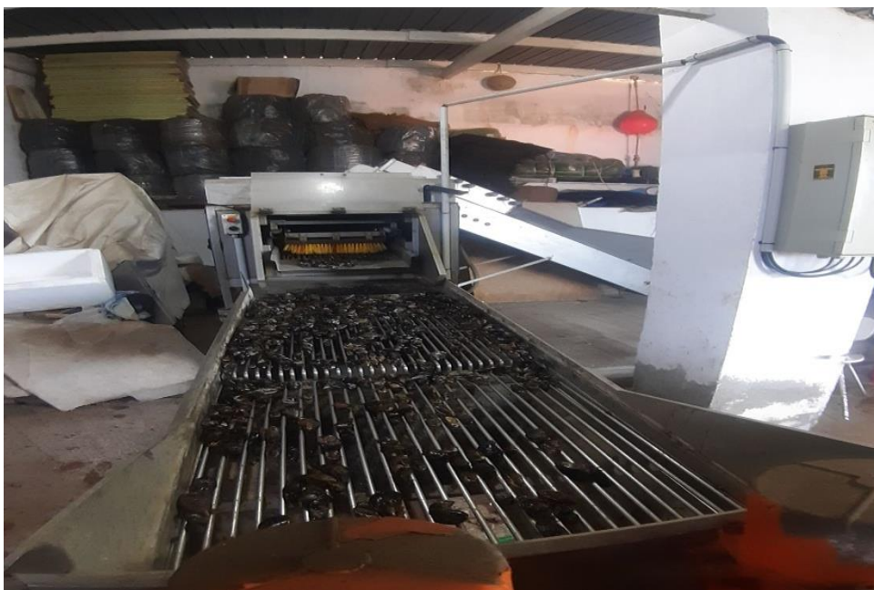
Figure 88: Calibreuse à moule. (Orca Marine, 2021)
