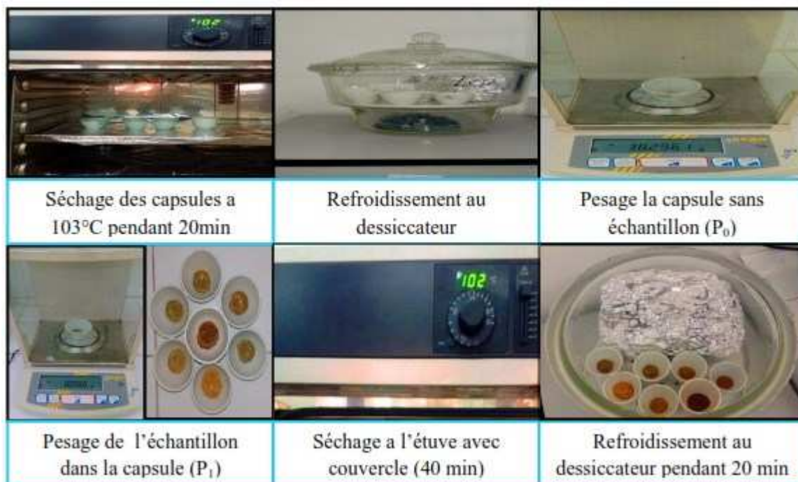
Figure II-15 étapes de la détermination du taux d'humidité
