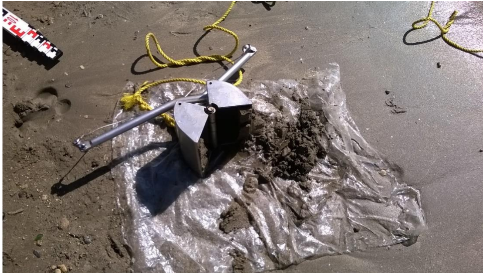
Photo 3.2 : Benne preneuse de type « Van-Veen ».
