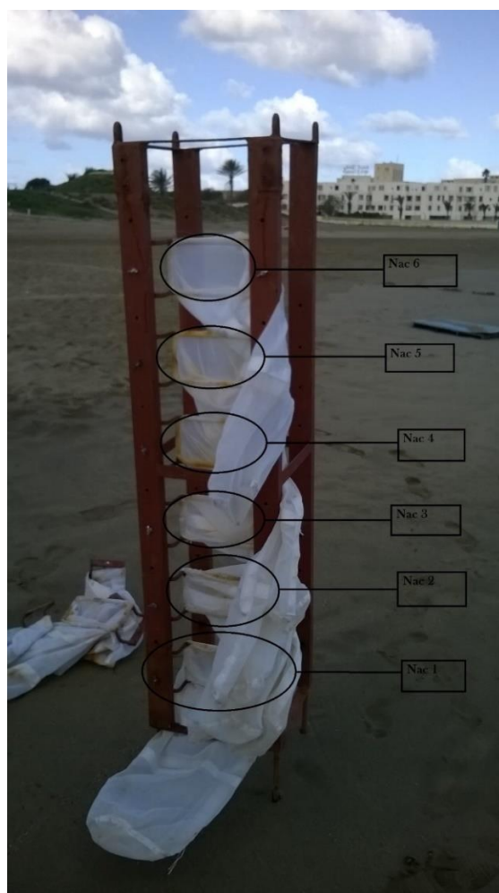
Photo : Numérotation des différentes nacelles du piège a sédiments
