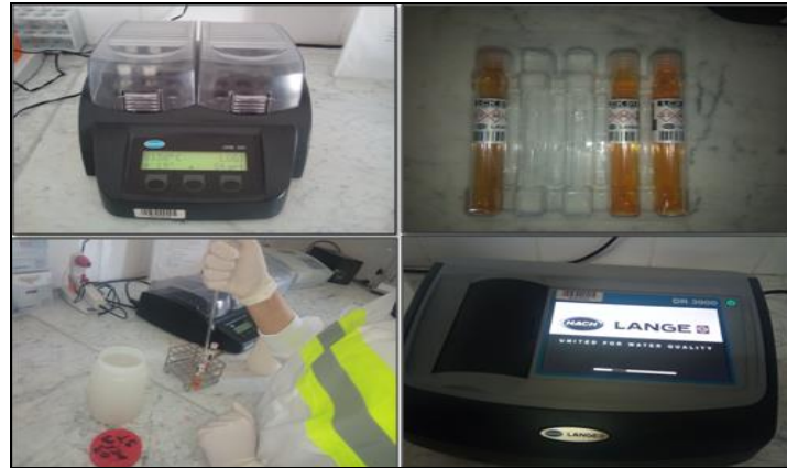
Figure II.3 : DCO mètre « HACH DRB200 », Kits : « LCK014 », appareil de mesure « HACH 2100 N »
