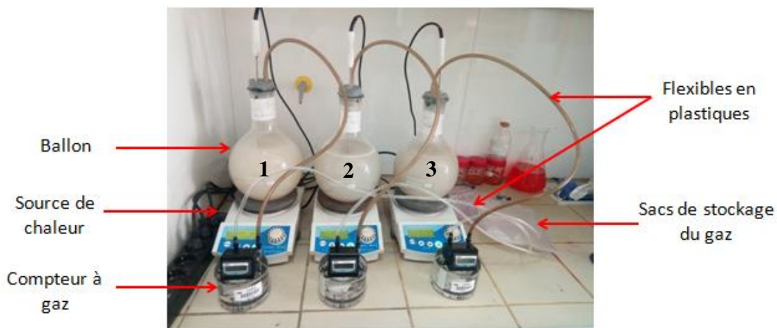
Figure II.16 : Dispositif expérimental de la biométhanisation des effluents bruts de DDA
