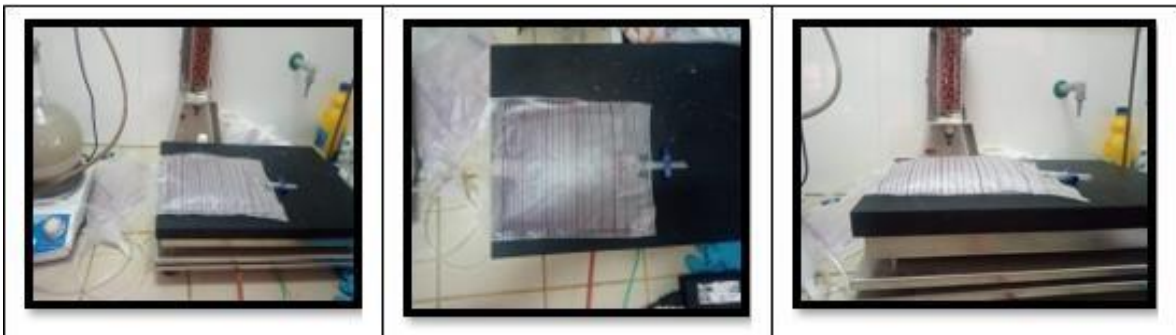
Figure III.6 : Biogaz issu de biométhanisation de l'effluent de DDA cumulé et stocké dans des poches (poches à urines)
