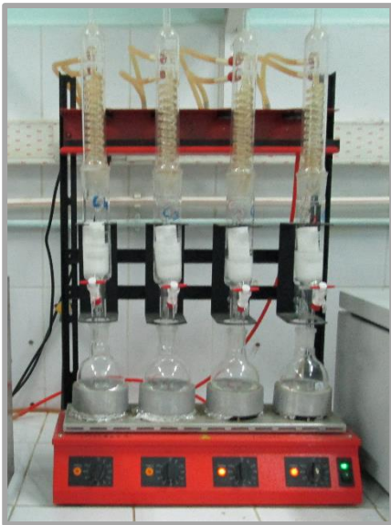
Figure 2.10: emplacement des ballons et des cartouches dans l'appareil de Soxhlet
