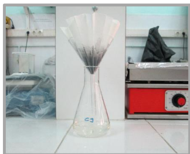
Figure 2.7: Filtration du minéralisat
