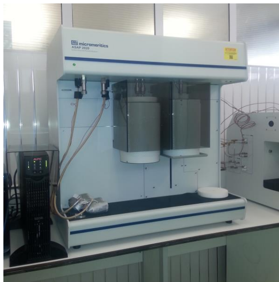
Figure II-4 photo numérique d'un Micromeritics ASAP 2020 pour analyser la BET des catalyseurs élaborés
