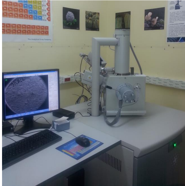
Figure II-3 photo numérique du MEB-EDX Quanta 250 utilisé pour l'analyse des catalyseurs élaborés
