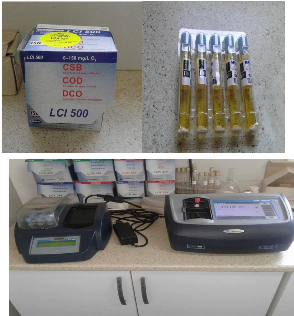
Figure II-9 Photo numérique montrant le DCO-mètre de marque DR 3900 ainsi que les réactifs de mesure
