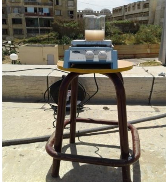
Figure II-11 : Photo numérique montrant le dispositif utilisé dans la photodégradation sous rayonnements solaires
