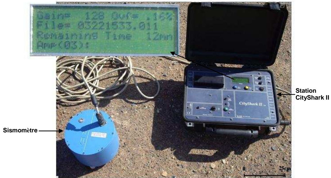
Figure 17. Matériel utilisé pour l'enregistrement du bruit de fond. Station d'acquisition Cityshark II et capteur Lennartz 5 secondes, à 3 composantes
