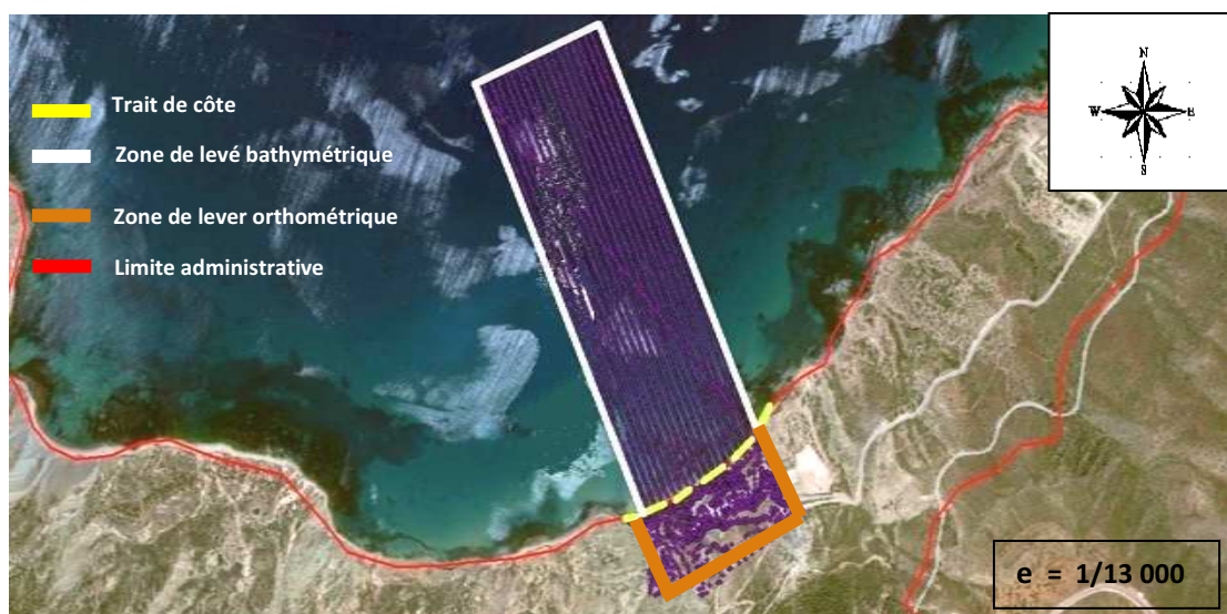
Figure 13 : Zone du levé bathymétrique et orthométrique dans la plage de Ain Franine
