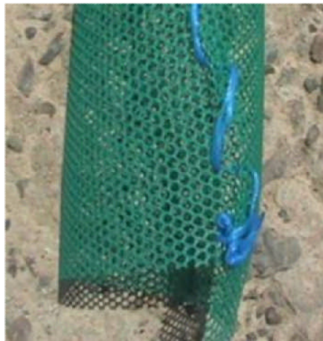
Figure 22 : La nappe en plastique servant de collecteurs.
