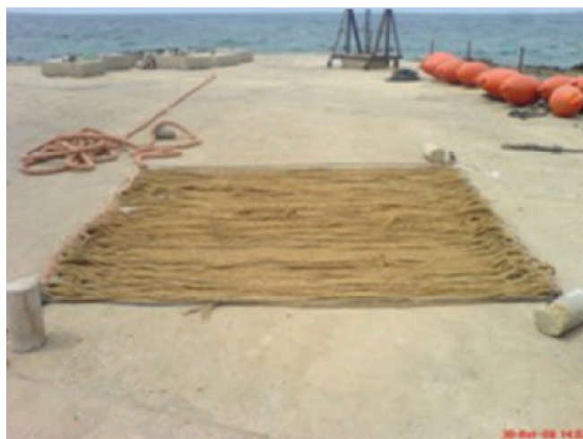
Figure 15 : La nappe en corde de coco.
