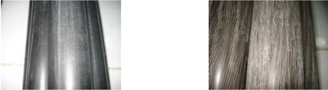
Figure 21 : Images des deux collecteurs de tube en PVC, à gauche avec surface lisse, à droite surface rugueuse.
