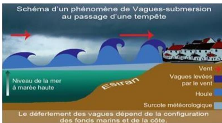
Fig I.04 : Schéma d'un phénomène de vagues-submersion au passage d'une tempête tirée (M.Hontarrède, Météo-France, La Rochelle 2014).
