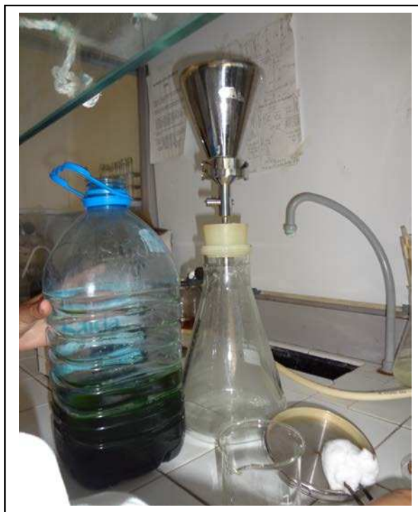
Figure 15: Récolte de la biomasse microalgales par filtration.
