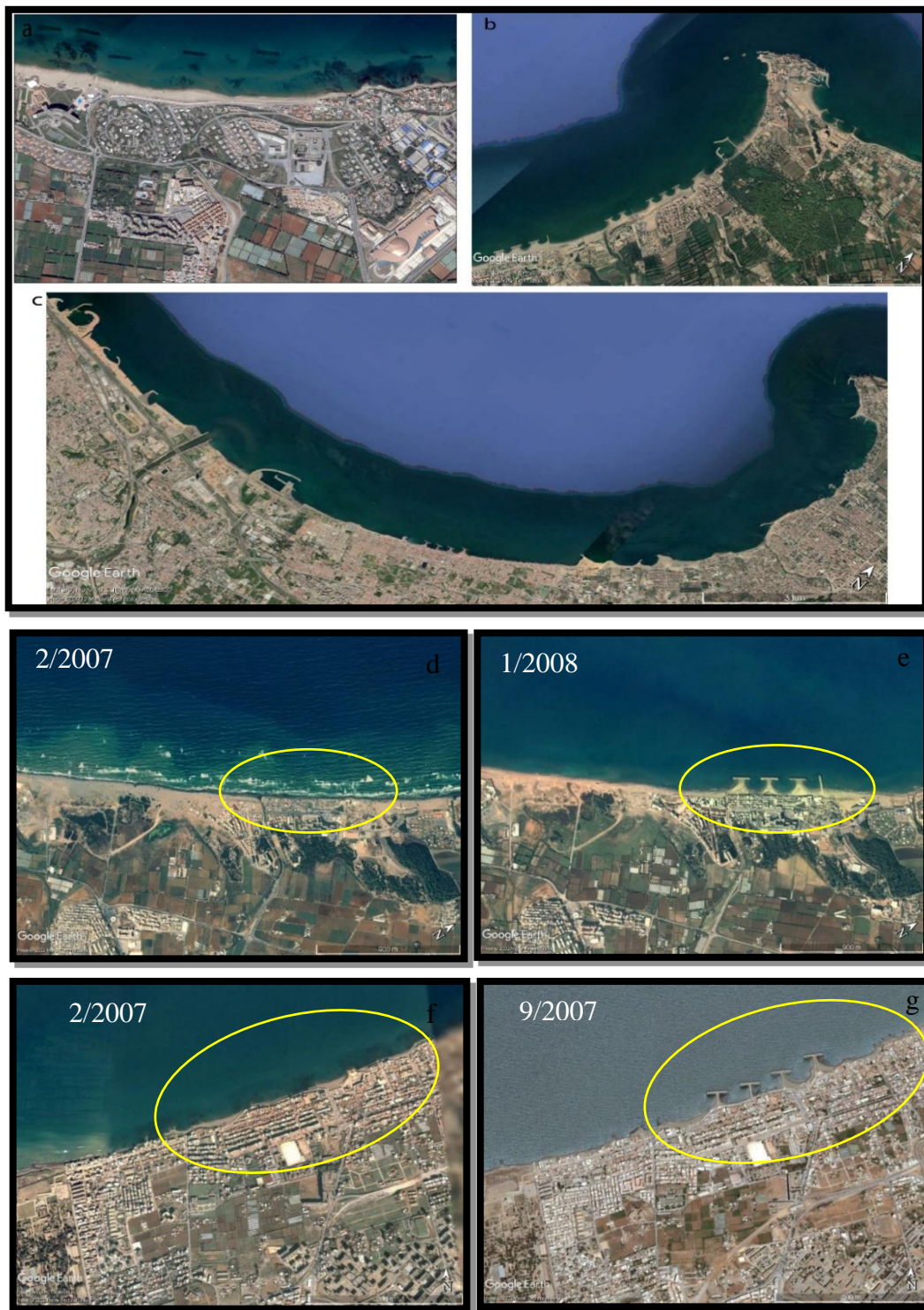
Figure V. 16 : (a) Installation de géotubes dans la baie d'El Djamil. (b) Epis et brise-lames le long des plages de la baie de Bou Ismail. (c) Epis et brise-lames lo long de la baie d'Alger. (d) Baie de Bou Ismail (section Sidi Fredj Ouest) avant la tempête de 2007. (e) Construction de brise-lames et d'un épi dans la baie de Bou Ismail (section Sidi Fredj Ouest) après la tempête de 2007. (f) Baie d'Alger Est avant la tempête de 2007. (g) Construction de brise-lames et d'un épi dans la baie d'Alger Est après la tempête de 2007.
