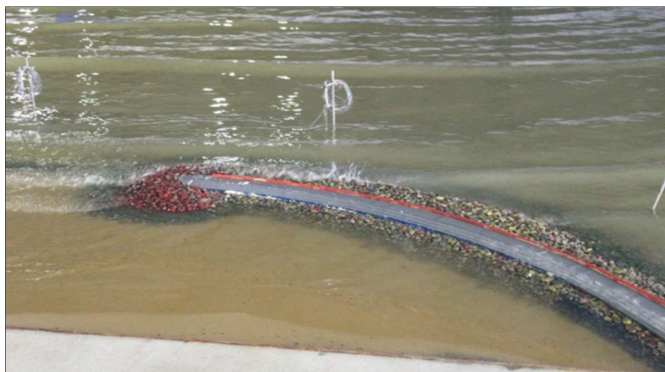
Figure n°32 : Images illustrant la maquette de la construction de la plage artificielle en bassin à houle
