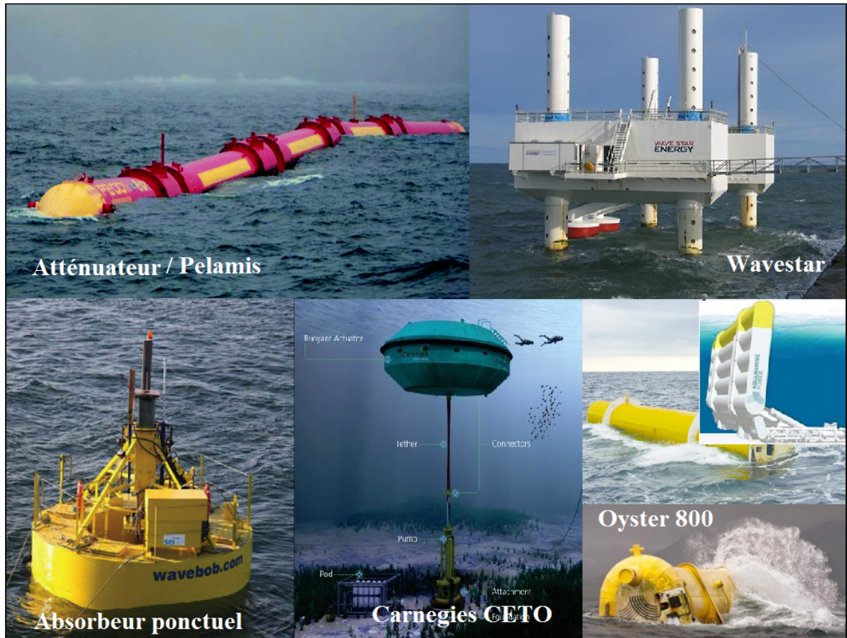
Figure I-8. Quelques convertisseurs d'énergies à corps mus par la houle (WAB), actuellement exploitables
