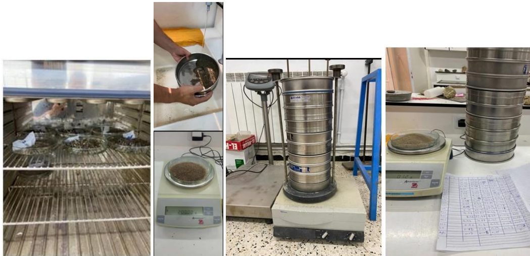
Figure 7 Étapes de l'analyse granulométrique (séchage, lavage, pesage et tamisage)
