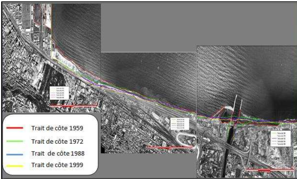
Figure n° 23 : Carte d'évolution du trait de côte 1959-1999 du linéaire sableux des « Sablettes » APPL ,2013.
