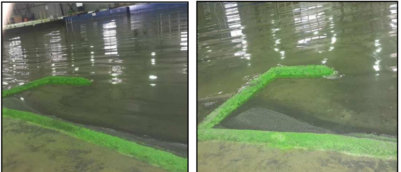
Figure n° 57 : Houle de secteur Nord-Ouest, de période 6s à gauche et de 8s à droite
