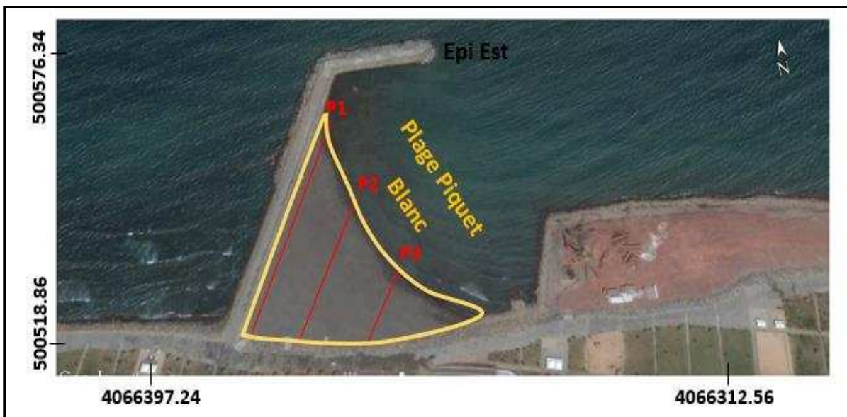
Figure n° 27 : Réalisation des profils de plage de « Piquet blanc » dans la zone des « Sablettes »
